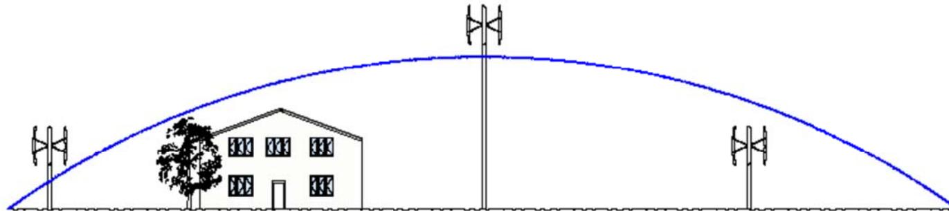
Bei **DACHMONTAGE** ist unbedingt auf stabile Bausubstanz zu achten die die entstehenden Vibrationen und Laufgeräusche nicht ins Hausinnere weiterleitet. Von einer Aufstellung auf Holzdachstühlen und Einfamilienhausdächern ist unbedingt abzuraten!
